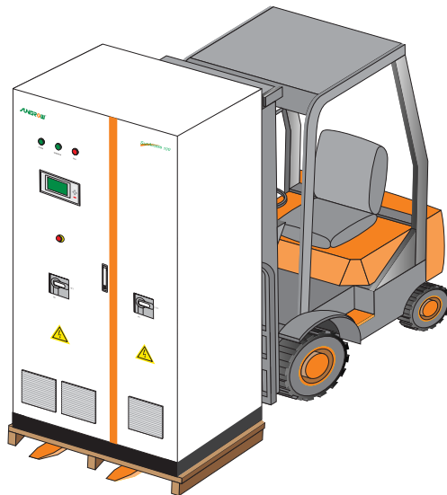
图7-2 叉车运输带木托盘的逆变器
